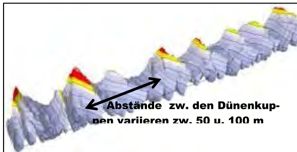
Abb. 5 - 26 Sohlstruktur in der Unterweser
